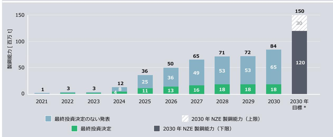
Agora Industry (2023)、Global Steel Transformation Tracker (2023)。注：発表されたプロジェクトはすべて、原則として水素対応 DRI プラントである。ただし現時点では、プロジェクトパイプラインの約 25% のみが最初から自然エネルギー水素で稼働することを意図している。他の DRI プラントはすべて、天然ガスまたは天然ガスと水素の混合ガスで稼働し、ほとんどの企業が、利用可能になったら最終的に 100% 低炭素の水素に切り替えることを表明している (Agora Industry、Global Steel Transformation Tracker を参照)。\*2030 年目標とは、IEA、IRENA、UN 2022 および我々自身のシナリオの 1.5°C 対応経路に沿うために必要となる排出量がほぼゼロの一次製鋼能力を指す。
